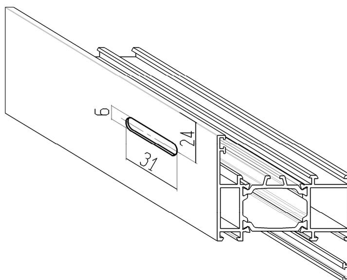
Fig. 4: Sezione e posizionamento delle asole del campione sottoposto a prova
