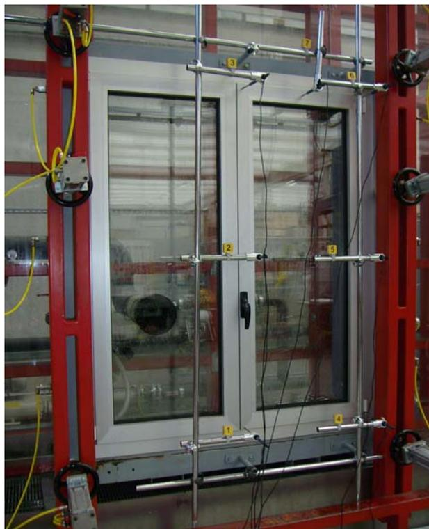
Foto 2: Campione sottoposto a prova durante i test di resistenza al vento (prova di deformazione)
