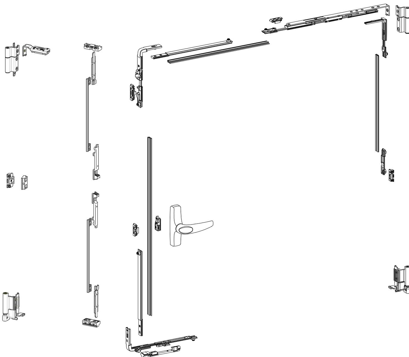
Fig. 5: Schema/esploso dei principali accessori del campione sottoposto a prova
